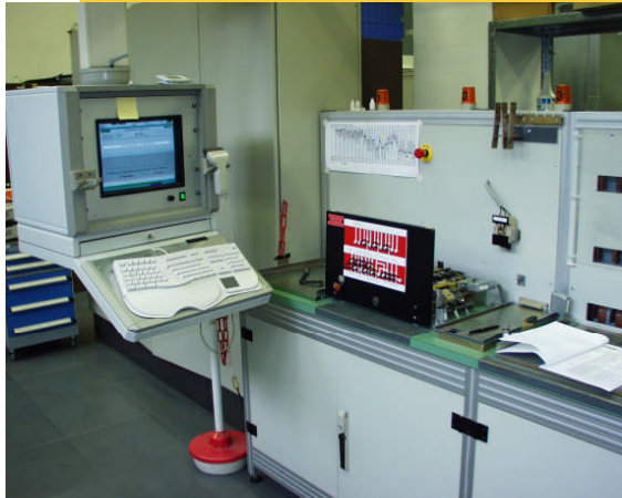
KPS 9001 Prüfstand mit Testein- schub für Prüfmittelprüfung
